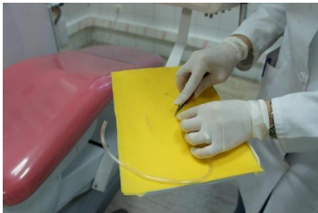
شکل ۳: نمونه آماده شده جهت قرار دادن در دستگاه UTM
